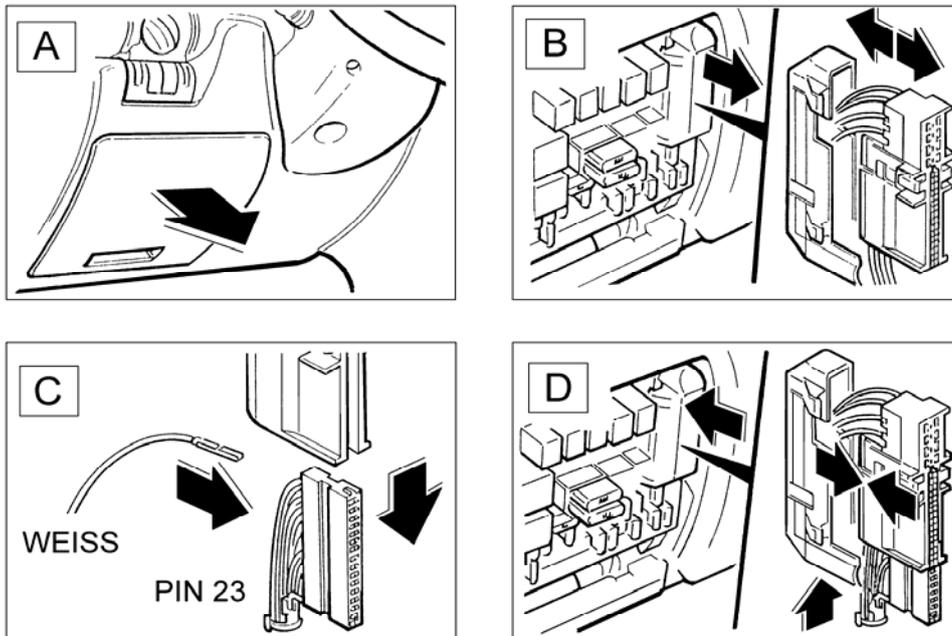
3.3 Kombi-Instrument, Lüftungseinheit und Lenksäulenverkleidung wieder einbauen.
