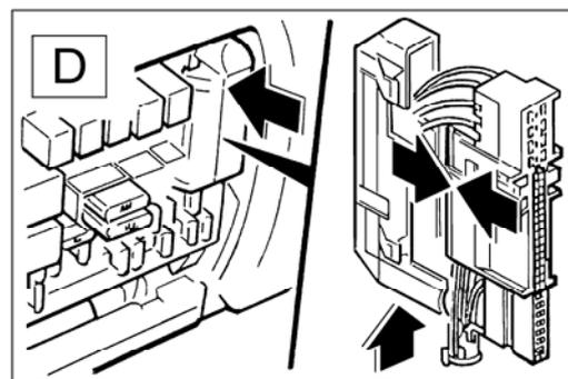
3.3 Kombi-Instrument, Lüftungseinheit und Lenksäulenverkleidung wieder einbauen.
