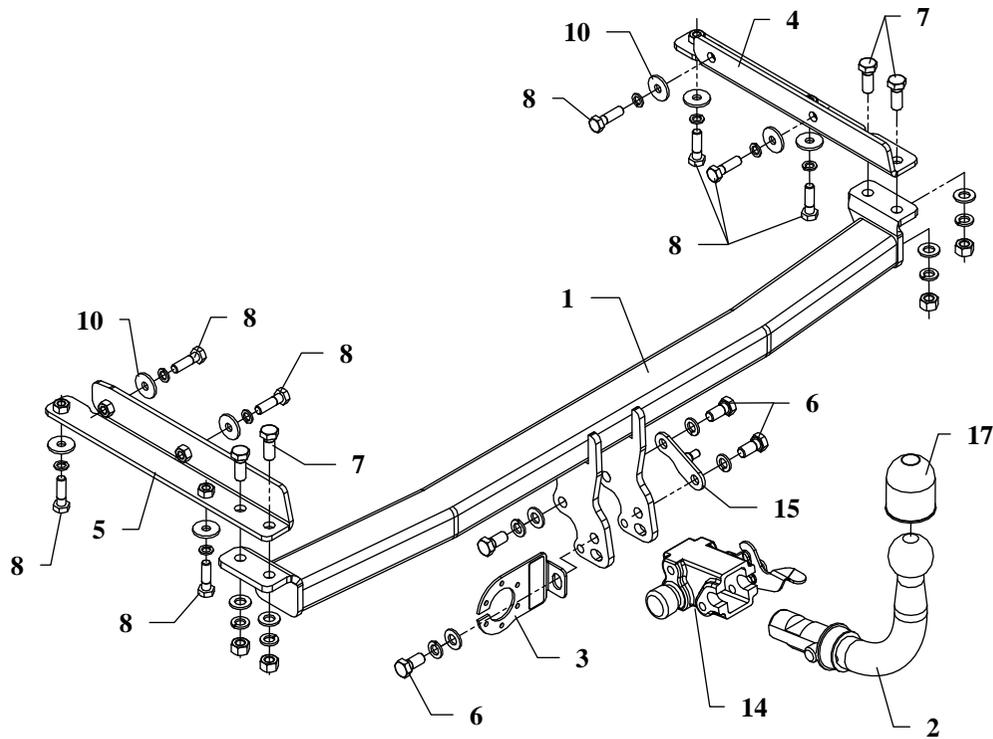
Die Anhängerkupplung (Katalognummer **V60A**) ist für folgende Fahrzeugtypen zugelassen: **NISSAN MICRA, 3/5 Tüer (K12)**, ab Bj. 02.2003, dient zum Ziehen der Anhänger mit der Gesamtlast von **1300 kg** und der Kugelstützlast von max. **75 kg**.
