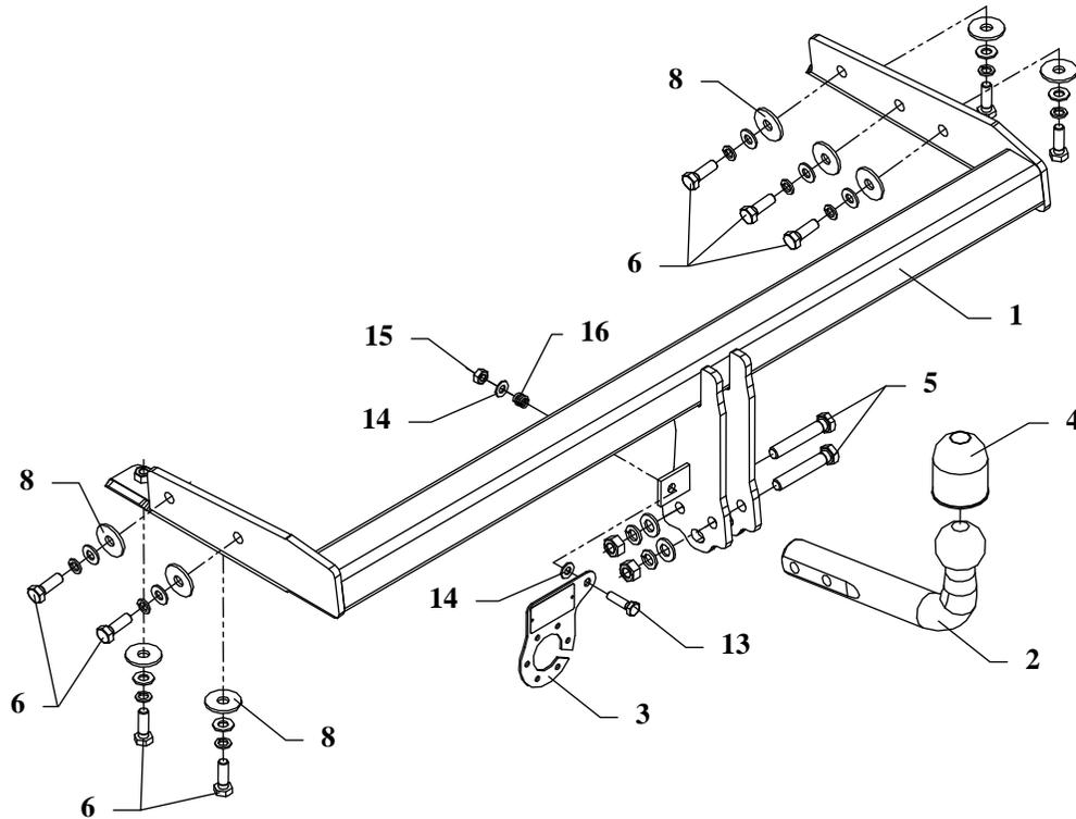
Die Anhängerkupplung (Katalognummer **V48**) ist für folgende Fahrzeugtypen zugelassen: **NISSAN ALMERA, 4 Türer, N16**, ab Bj. 03.2000 bis 2006, dient zum ziehen der Anhänger mit der Gesamtlast von **1500 kg** und der Kugelstützlast von max. **75 kg**.
