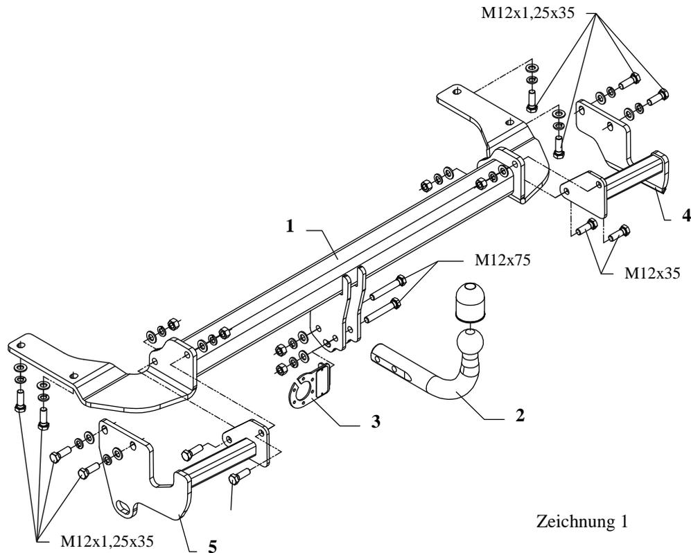
Die Anhängerkupplung (Katalognummer **Z34**) ist für folgende Fahrzeugtypen zugelassen: **MITSUBISHI GRANDIS**, ab Bj. 2004, dient zum ziehen der Anhänger mit der Gesamtlast von **1800 kg** und der Kugelstützlast von **max.85 kg**.
