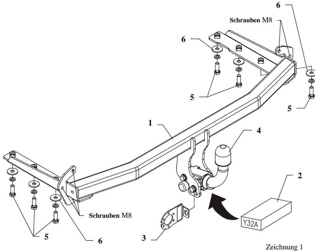
Die Anhängerkupplung (Katalognummer **Y32A**) ist für folgende Fahrzeugtypen zugelassen: **HONDA CIVIC 5 Türrer**, ab Bj. 2006 bis 12.2011, dient zum ziehen der Anhänger mit der Gesamtlast von **1500 kg** und der Kugelstützlast von max. **75 kg**.
