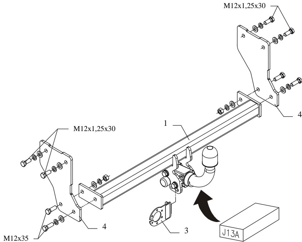
Die Anhängerkupplung (Katalognummer **J13A**) ist für folgende Fahrzeugtypen zugelassen: **HYUNDAI ATOS 5 Tüerer**, ab Bj. 1998, dient zum Ziehen der Anhänger mit der Gesamtlast von **700 kg** und der Kugelstützlast von max. **50 kg**.
