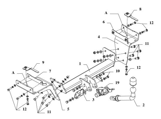
Die Anhängekupplung (Katalognummer  $\mathbf{R30A}$ ) ist für folgende Fahrzeugtypen zugelassen: FIAT STILO ,3/5 Türer, ab Bj. 2002 bis 2006, dient zum Ziehen der Anhänger mit der Gesamtlast von  $\mathbf{1400}$  kg und der Kugelstützlast von  $\mathbf{max.60}$  kg.
