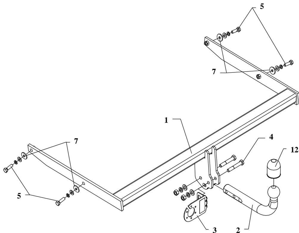
Die Anhängerkupplung (Katalognummer **C48**) ist für folgende Fahrzeugtypen zugelassen: **FORD FOCUS II SEDAN**, ab Bj. 2005, dient zum Ziehen der Anhänger mit der Gesamtlast von **1500 kg** und der Kugelstützlast von max. **75 kg**.
