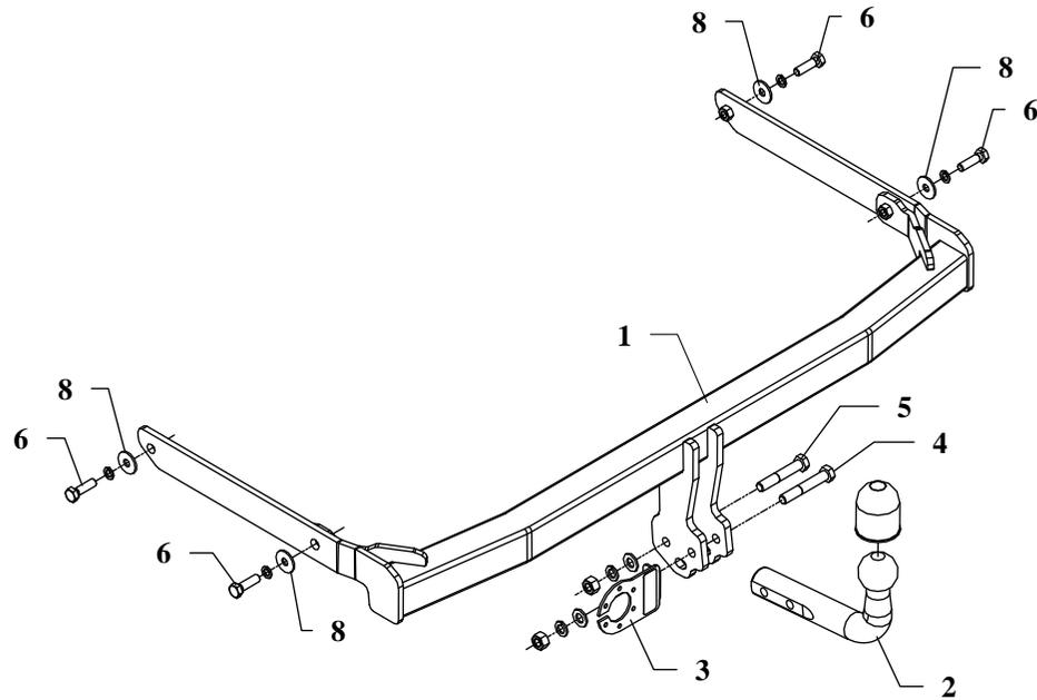
Die Anhängerkupplung (Katalognummer **C42**) ist für folgende Fahrzeugtypen zugelassen: **FORD FIESTA**, ab Bj. 01.2002 bis 2008, dient zum ziehen der Anhänger mit der Gesamtlast von **900 kg** und der Kugelstützlast von max. **50 kg**.
