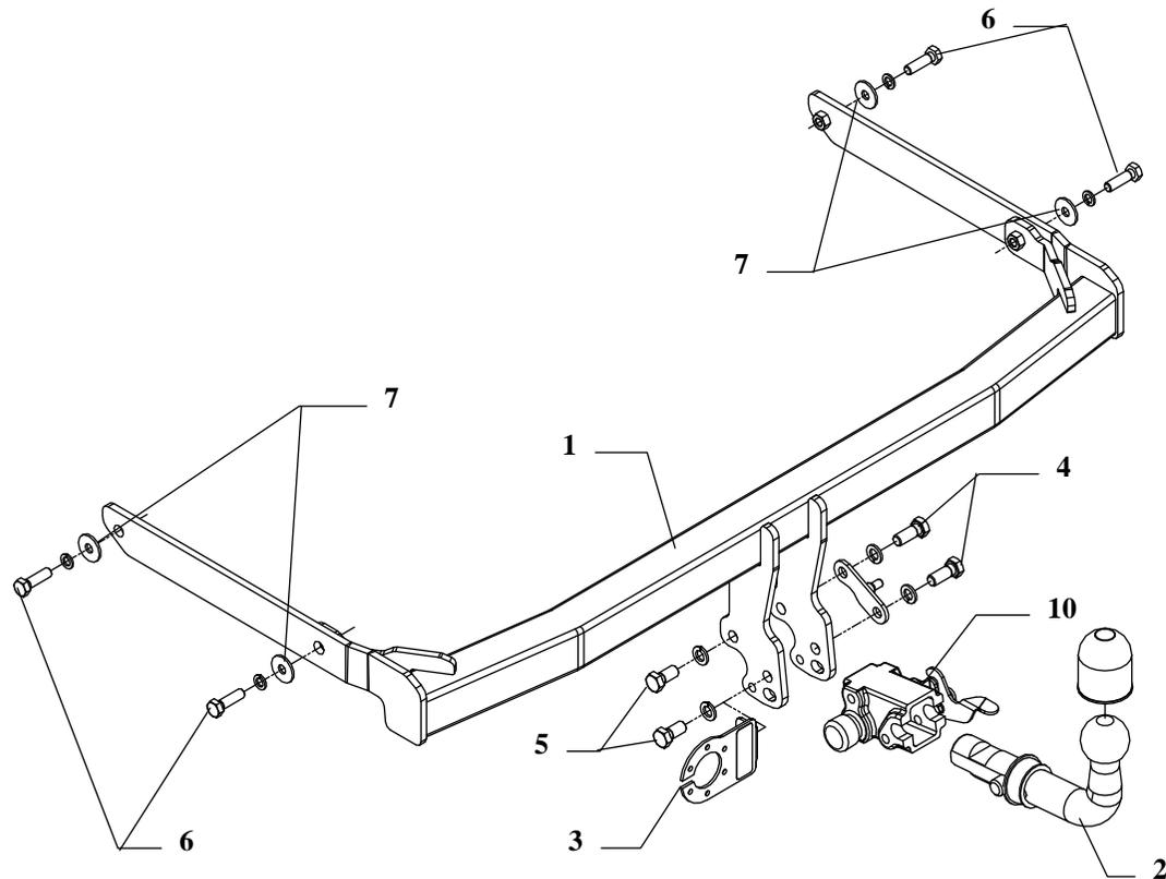
Die Anhängerkupplung (Katalognummer **C42A**) ist für folgende Fahrzeugtypen zugelassen: **FORD FIESTA**, ab Bj. 01.2002 bis 2008, dient zum Ziehen der Anhänger mit der Gesamtlast von **900 kg** und der Kugelstützlast von **max.50 kg**.
