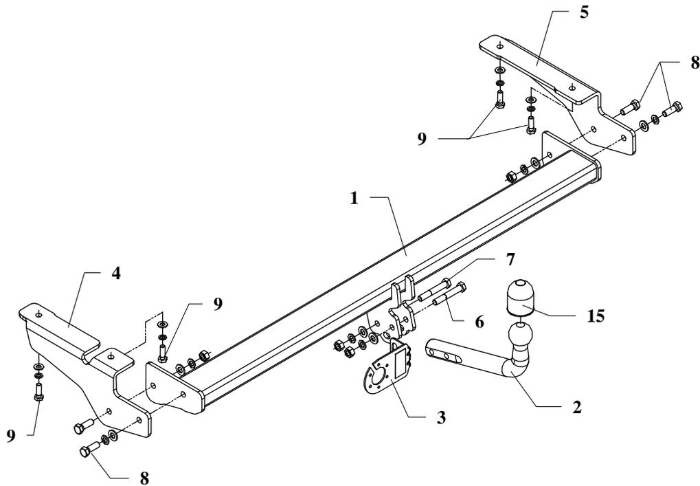
Die Anhängerkupplung (Katalognummer **P24**) ist für folgende Fahrzeugtypen zugelassen: **CITROEN C5 I, 4 Tüer**, ab Bj. 2000 bis 09.2004, dient zum ziehen der Anhänger mit der Gesamtlast von **1600 kg** und der Kugelstützlast von max.**85 kg**.
