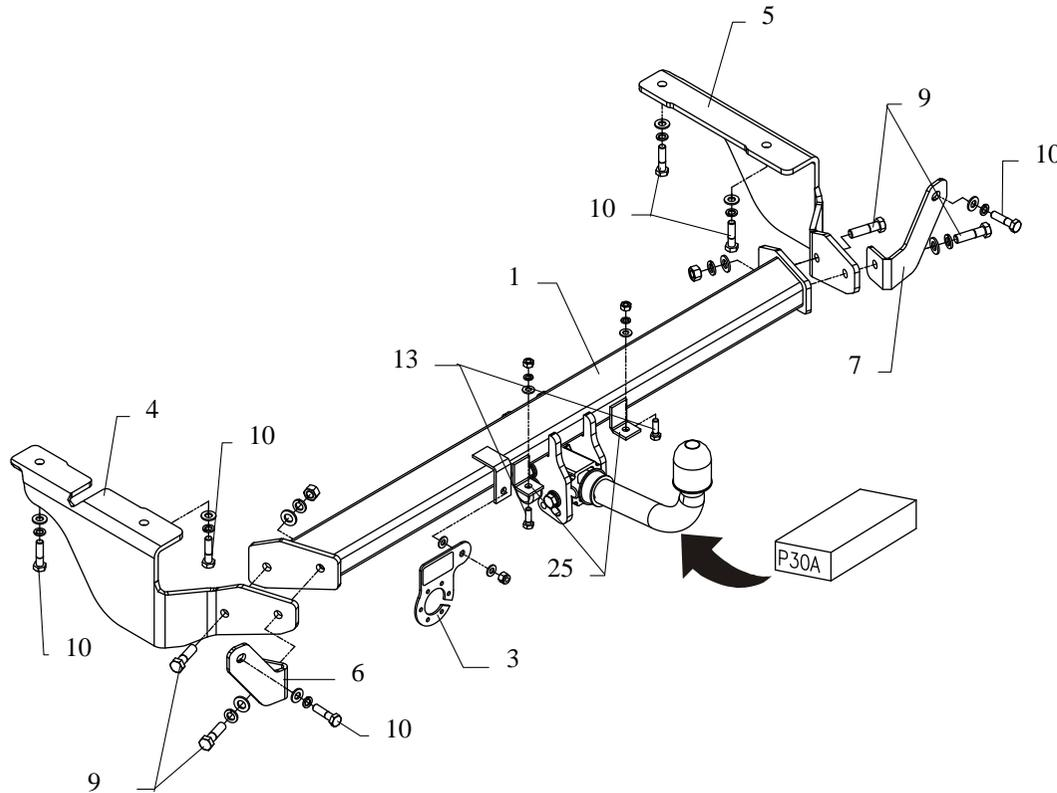
Die Anhängerkupplung (Katalognummer **P30A**) ist für folgende Fahrzeugtypen zugelassen: **CITROEN C5 I, KOMBI**, ab Bj. 10.2004 bis 03.2008, dient zum ziehen der Anhänger mit der Gesamtlast von **1600 kg** und der Kugelstützlast von max. **85 kg**.
