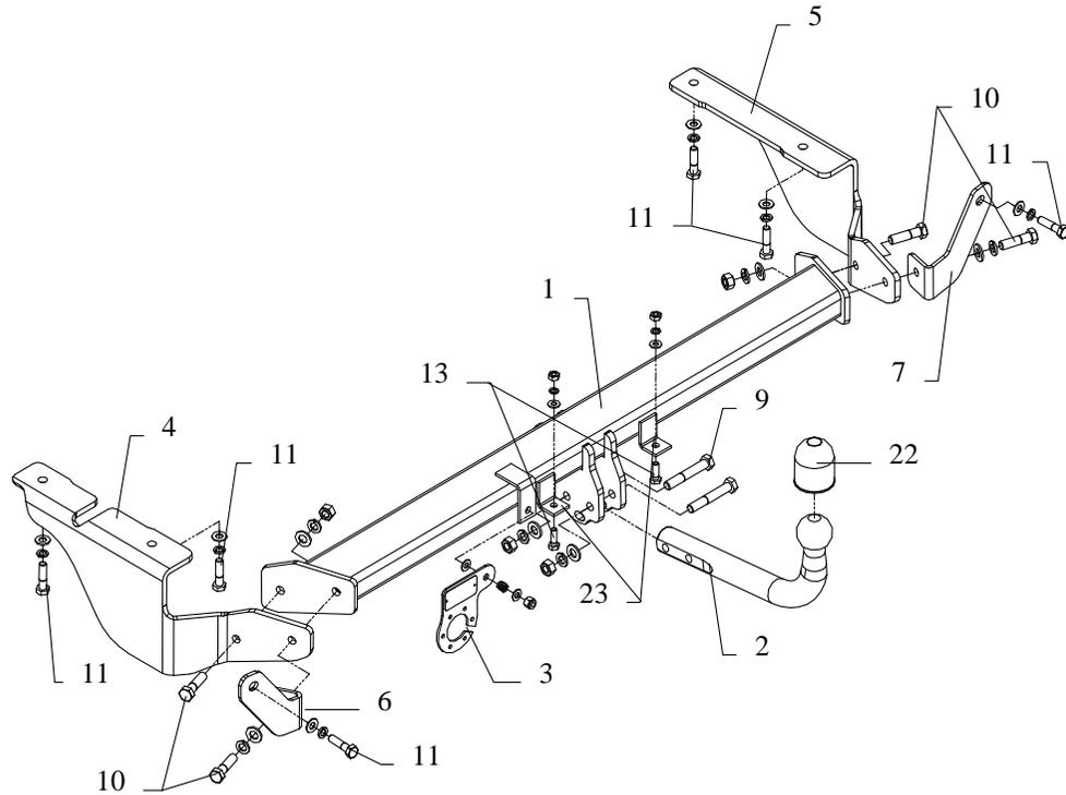
Die Anhängerkupplung (Katalognummer **P30**) ist für folgende Fahrzeugtypen zugelassen: **CITROEN C5 I, KOMBI**, ab Bj. 10.2004 bis 03.2008, dient zum ziehen der Anhänger mit der Gesamtlast von **1600 kg** und der Kugelstützlast von max. **85 kg**.
